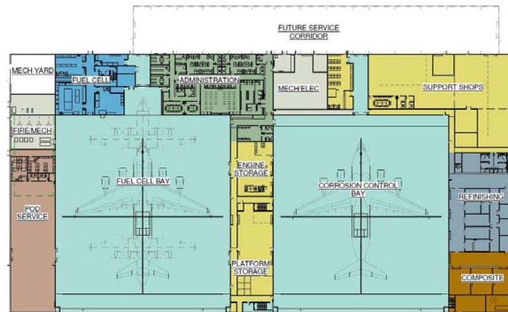
Overall Floor Plan of Hangar 1 Overall: 190 m (w) x 97 m (d) x 29 m (h) Each hangar bay: 66 m (w) x 74 m (d) x 21 m (h)
